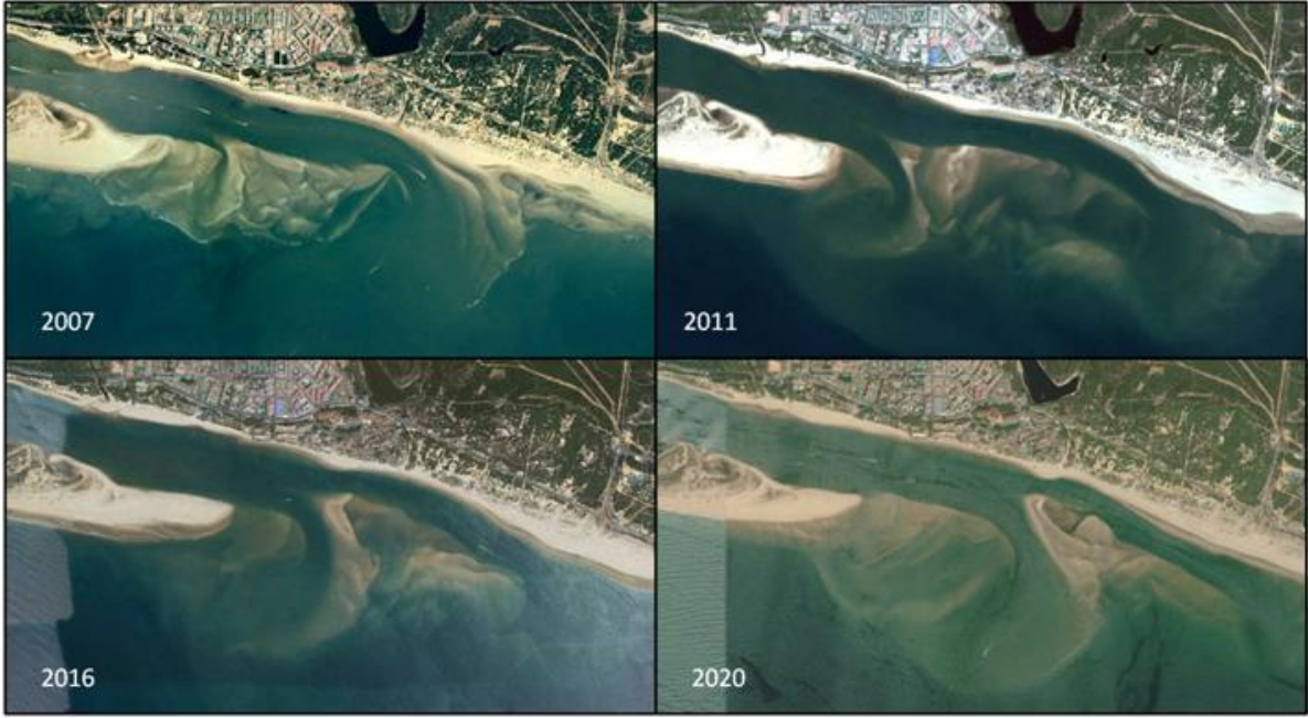
Figura 5.- Fotografías aéreas del sistema de deltas de refluo marea y la playa de El Portil en los años 2007, 2011, 2016 y 2020. La comparación de estos fotogramas permite visualizar el desplazamiento hacia el Este de los canales y los bajos arenosos de las plataformas de batida del oleaje.
