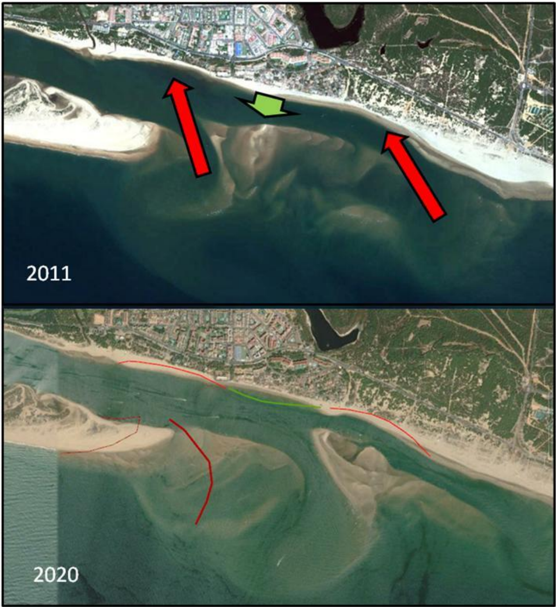
Figura 6.- Fotografías aéreas de 2011 y 2020. Las flechas rojas de la fotografía superior muestran la entrada del oleaje a través de los canales creando una zona erosiva al llegar a la playa. La flecha verde indica una zona acumulativa a la protección de los bajos. En la fotografía inferior
